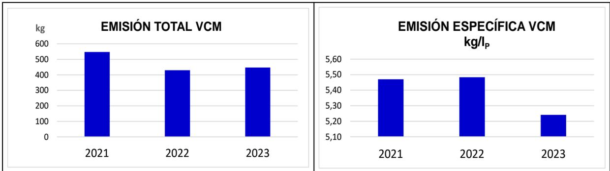
Ligera reducción por cambios y ajustes operativos en la planta de producción de PVC y por la bajada de producción. Hay que destacar, la tendencia a la baja en la emisión específica durante el año 2023.
